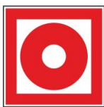
1. Кнопка включения систем пожарной автоматики
